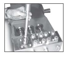
4) Take out valve assemblies (52 & 51) using either tool (part #07662) or a stud bolt.
